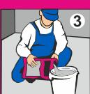
Для подготовки раствора залейте водопроводную воду комнатной температуры в чистую ёмкость из расчёта 0,26-0,29 л воды на 1 кг сухой смеси (на 1 мешок 20 кг - 5,2-5,8 л воды).
